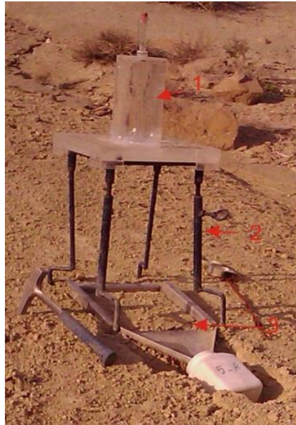
شکل ۳- شمایی از دستگاه شبیه‌ساز باران
