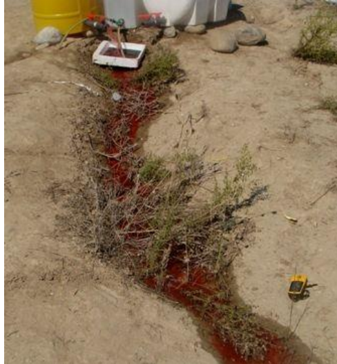
شکل ۲: نمایی از مخازن تغذیه و ردیاب رنگی
