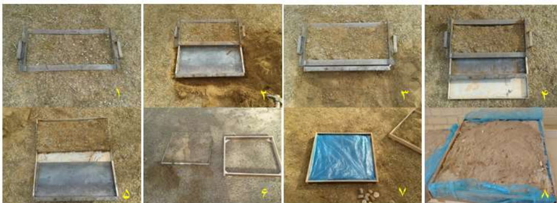
شکل ۲: تصاویری از روش نمونه‌برداری خاک به صورت دست‌نخورده
