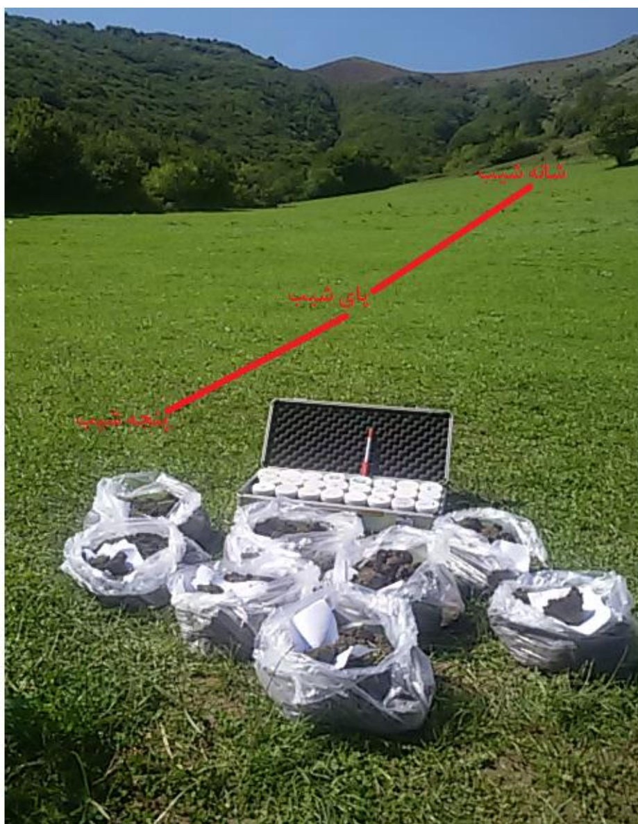
شکل ۱- نمونه‌برداری دست‌خورده و دست‌نخورده از خاک اراضی مرتعی و جنگلی گردنه حیران استان اردبیل.
