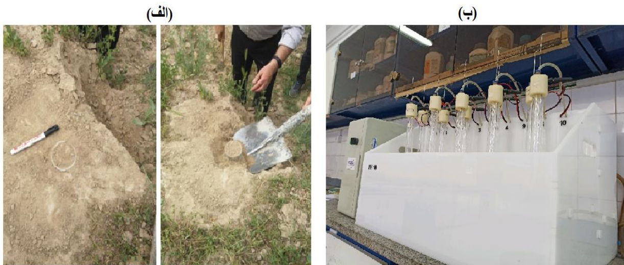
شکل ۳: مراحل نمونه‌برداری از لایه‌ی سطحی خاک توسط سیلندر نمونه‌برداری خاک (الف) و دستگاه اتوماسیون اندازه‌گیری هدایت هیدرولیکی اشباع خاک به روش بارافتان (ب)
