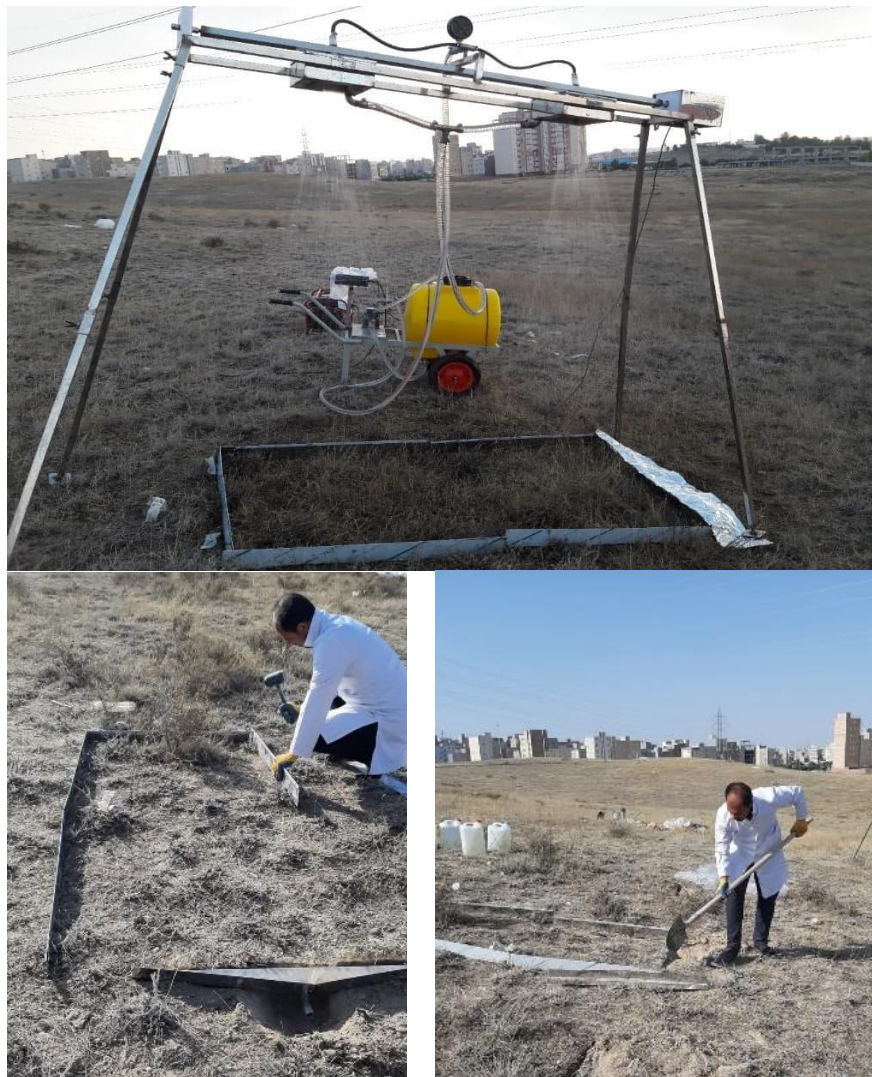
شکل ۳: نمایی از شبیه‌ساز باران به همراه کرت‌های فرسایشی مورد استفاده در پژوهش حاضر
