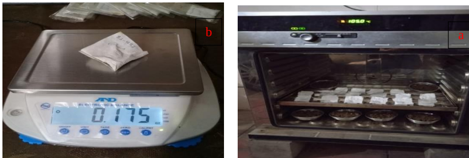
شکل ۴a: خشک کردن نمونه‌های کاغذ صافی همراه رسوب توسط دستگاه آون و ۴b: وزن کردن نمونه‌های کاغذ صافی همراه رسوب
