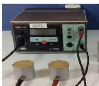
شکل ۶: طرح کلی از نحوه عملکرد دستگاه اولتراسونیک و دورنمای دستگاه
