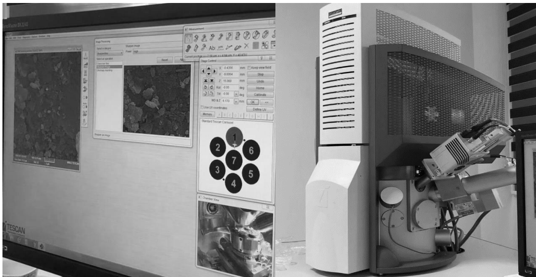
شکل ۴: تصویر دستگاه SEM و نرم‌افزارهای نمایش‌های تصویر ارائه شده از ریزگردهای مورد مطالعه
