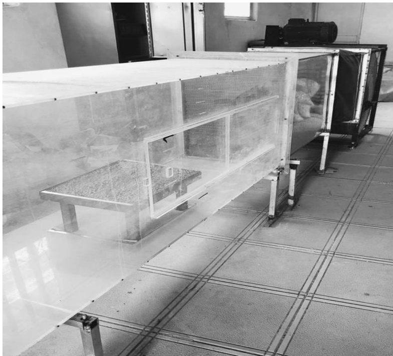
شکل ۲: تصویر دستگاه تونل بادی گروه علوم و مهندسی خاک دانشگاه تبریز
