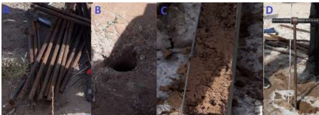
شکل ۳: تصاویر برداشت نمونه برداری با مغزه گیر در پلایای جازموریان
