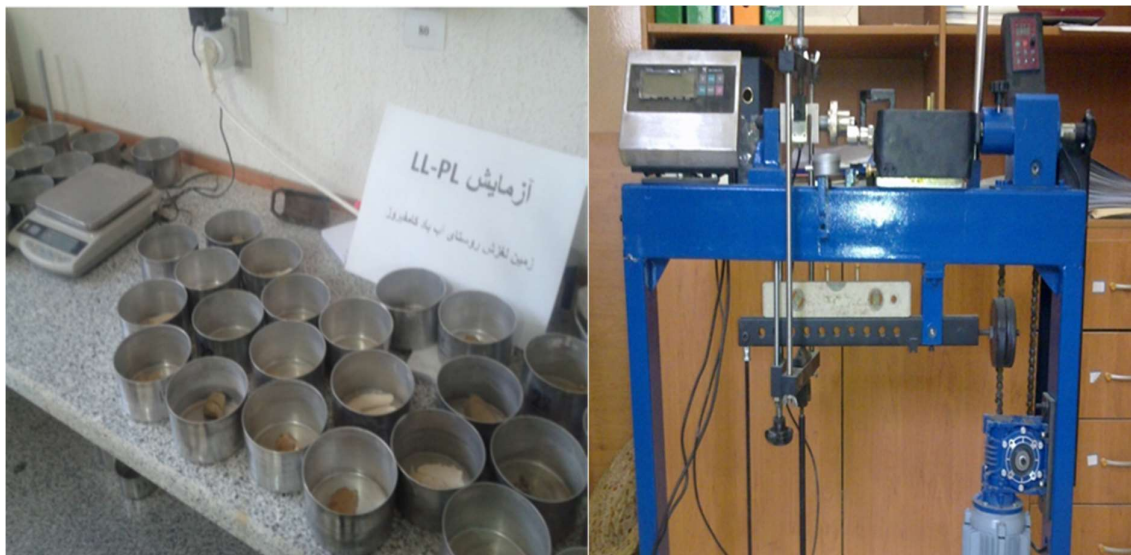
شکل ۳: دستگاه آزمایش برش مستقیم
