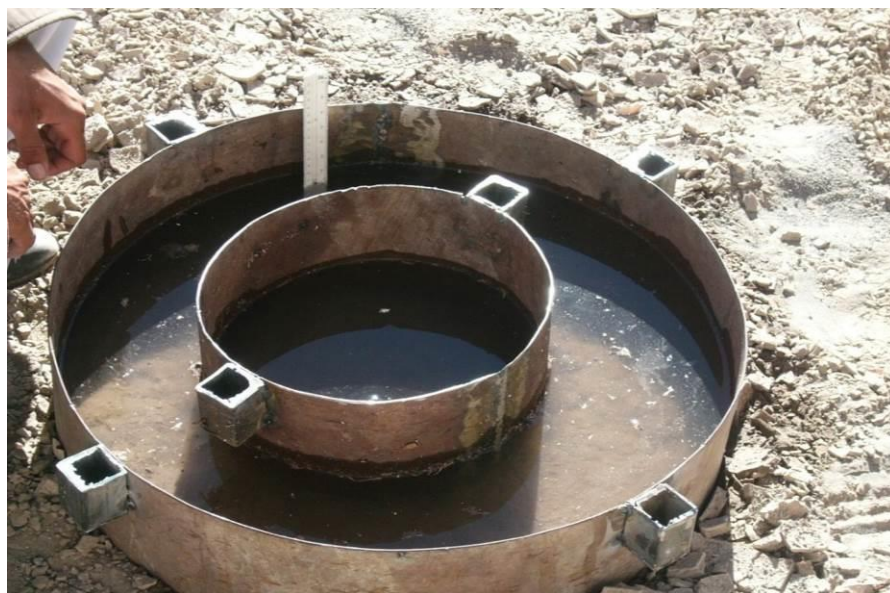
شکل ۶: نمایی از اندازه‌گیری میزان نفوذپذیری آب در خاک منطقه‌ی مورد مطالعه
