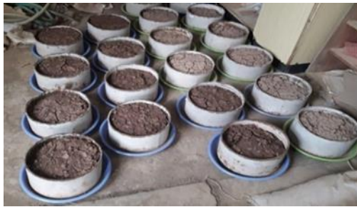
شکل ۲: الف) نمایی از روش نمونه برداری و ب) نمایی از استوانه‌های فلزی حاوی خاک دست‌نخورده در آزمایشگاه
