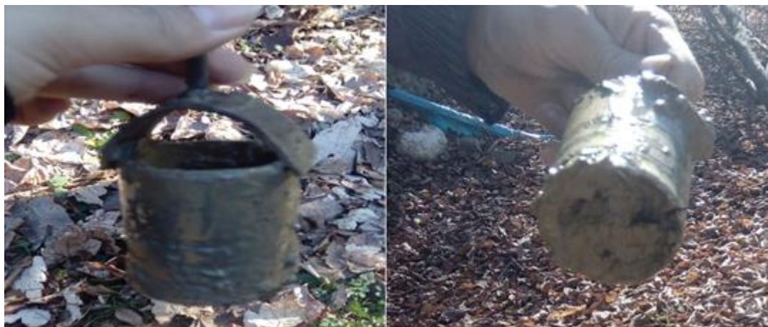
شکل ۵: استوانه فلزی مخصوص برای اندازه‌گیری وزن مخصوص ظاهری
