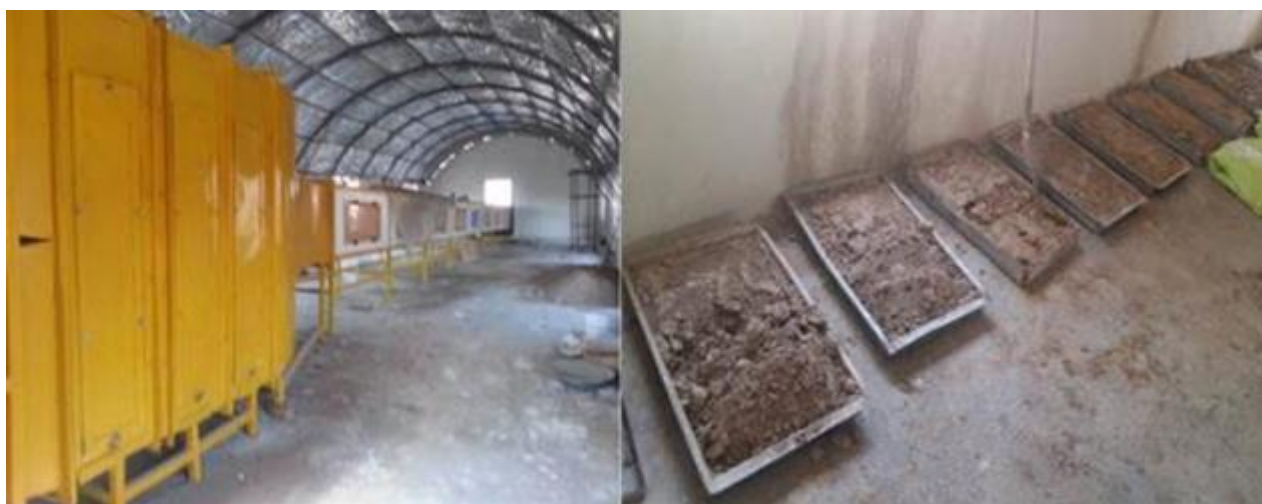
شکل ۳: آزمایشگاه فرسایش بادی، تونل باد ثابت (چپ) و بخش تنظیمات (بالا) و نمونه تحت آزمایش (راست)
