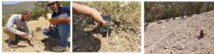
شکل ۲: اندازه‌گیری میدانی فرسایش و رسوب به کمک پیکه‌های فرسایشی در منطقه
