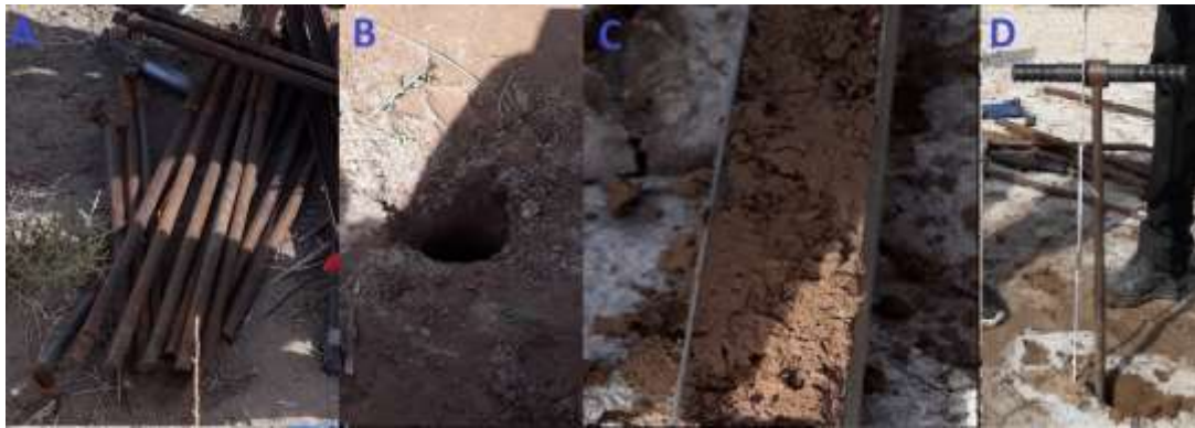
شکل ۳: تصاویر برداشت نمونه برداری با مغزه گیر در پلاهای جازموریان
