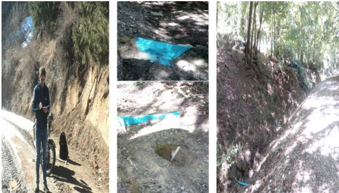
شکل ۲: جمع‌آوری اطلاعات میدانی و نصب تله‌ی رسوب‌گیر در قطعات مورد مطالعه
