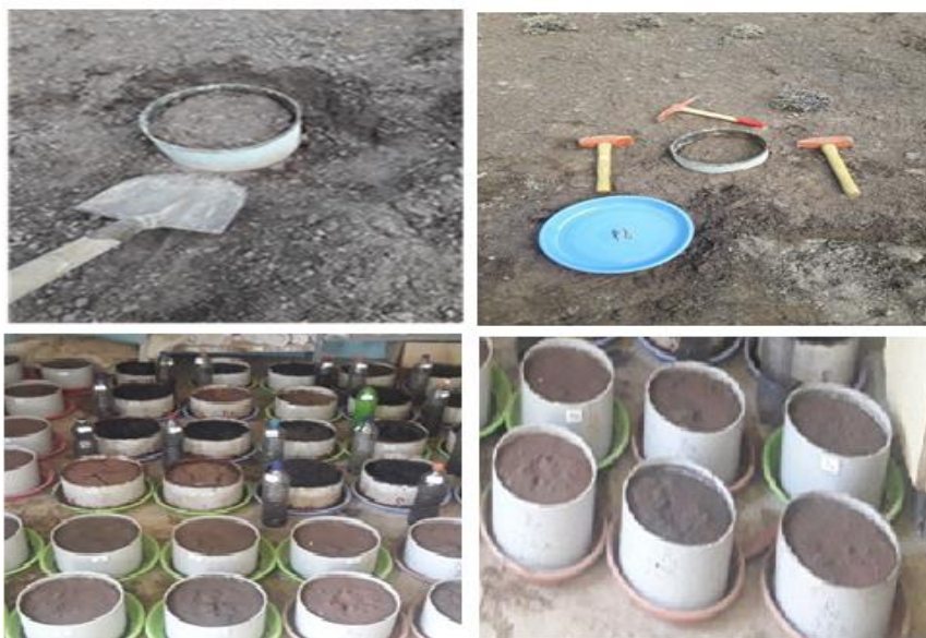
شکل ۲: نمایی از روش نمونه‌برداری و استوانه‌های فلزی حاوی خاک دست‌نخورده در آزمایشگاه
