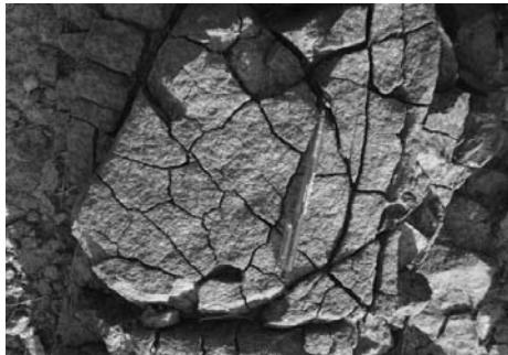
شکل ۲- نمایی از سیستم‌های متعدد درزه در داخل توده دیوریتی و شکسته شدن آن‌ها به شکل بلوکی (دید عکس به سمت جنوب).
