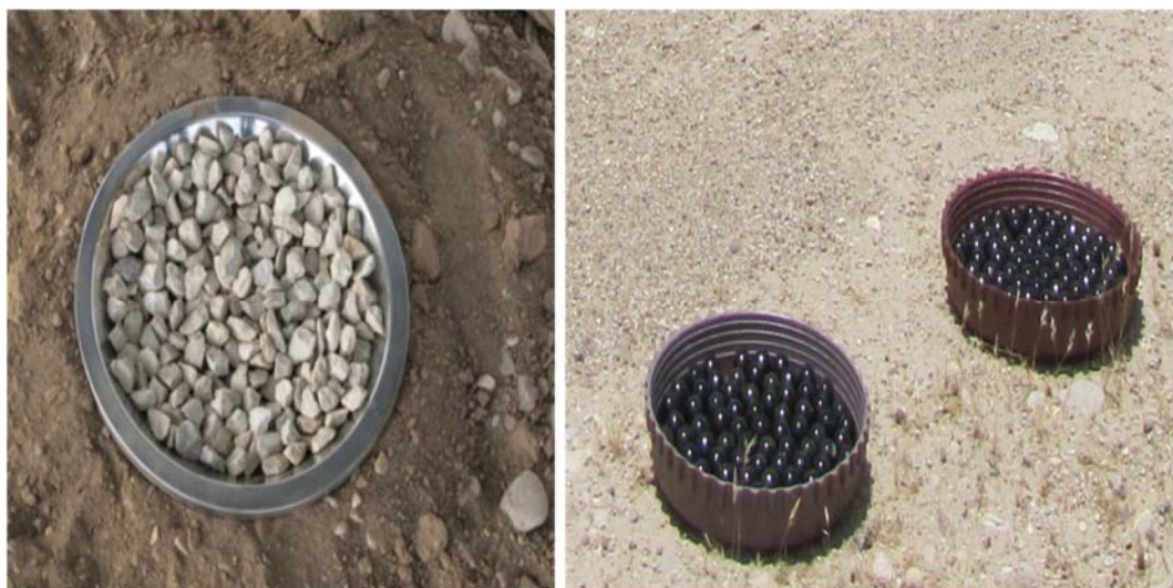
شکل ۲- نمونه‌هایی از رسوب‌گیر MDCO طراحی شده جهت نمونه‌برداری از رسوبات
