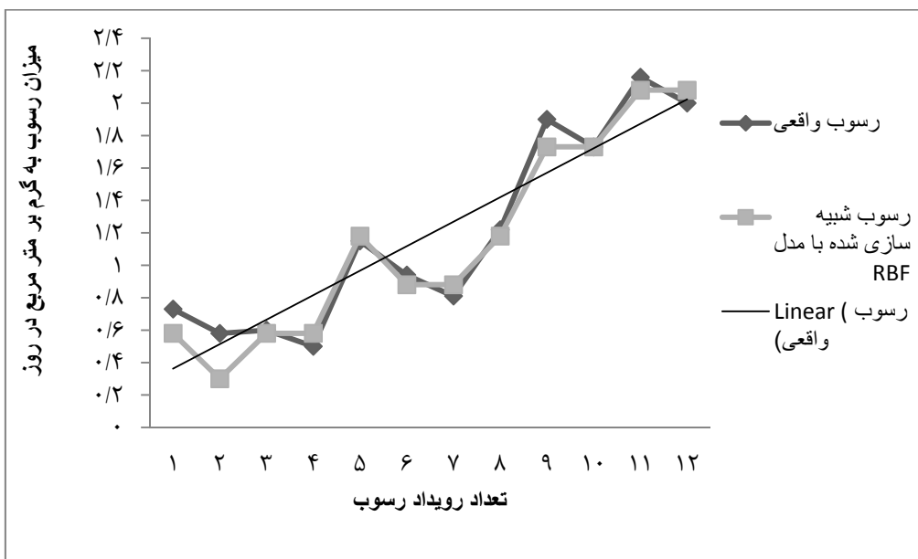
نمودار ۸- نمودار شبیه‌سازی شده نسبت به نمودار مشاهده شده در سایت گیاهی Tamarix
