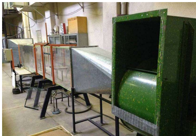
شکل ۳: تصویری از تونل باد مورد استفاده واقع در دانشکده‌ی مکانیک دانشگاه تبریز
