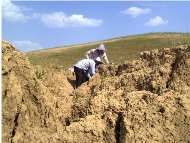
شکل ۳: نمونه برداری خاک از بخش هدکت خندق
