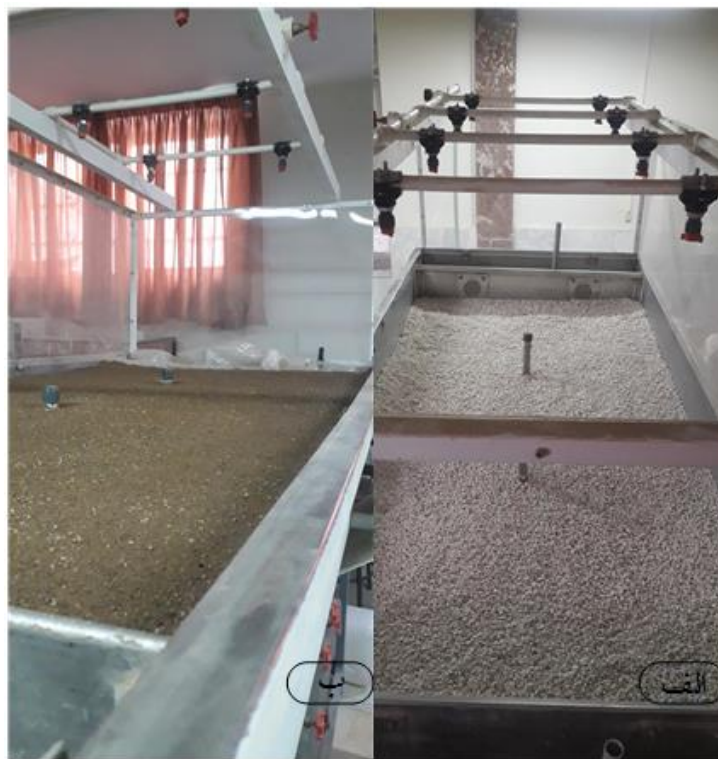
شکل ۴: لایه زهکش (الف) و سطح خاک آماده در هر تکرار آزمایش (ب)
