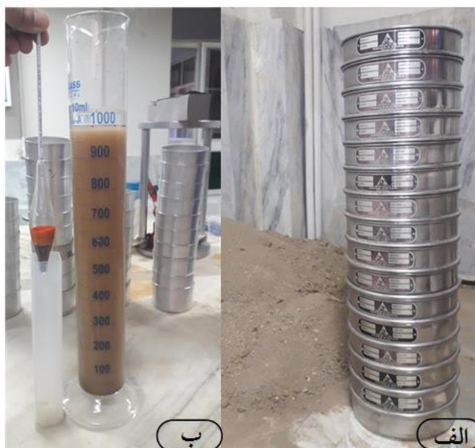
شکل ۲: دانه‌بندی خاک (الف) و تعیین بافت آن به روش هیدرومتری (ب)
