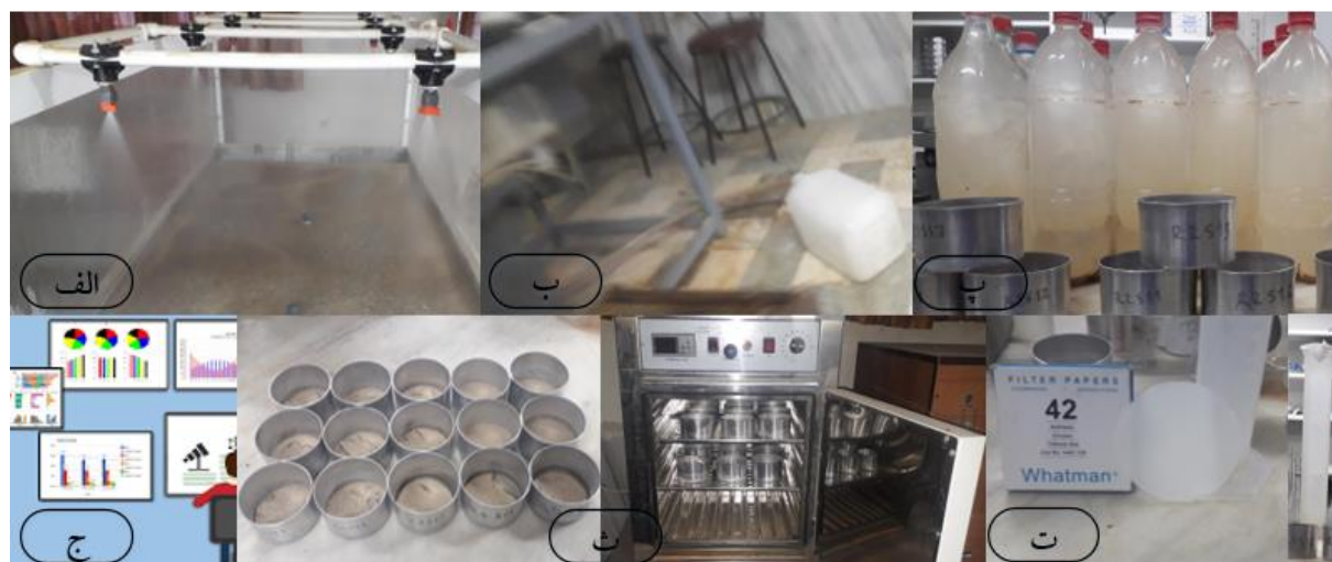
شکل ۵: شبیه‌سازی باران (الف)، اندازه‌گیری رواناب و رسوب (ب)، برداشت حجم نمونه (پ)، جداسازی رسوب (ت)، خشک کردن و توزین رسوب (ث) و اجرای تحلیل‌های آماری (ج)
