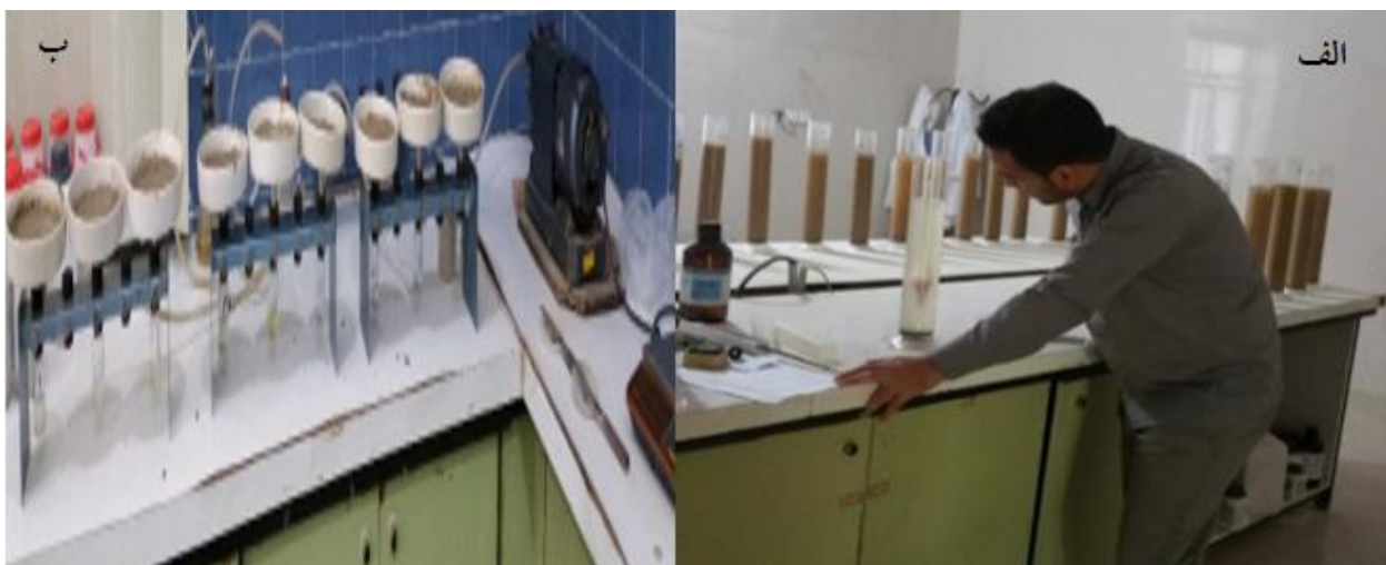
شکل ۶: نمایی از انجام آزمایش هیدرومتری (الف) و عصاره‌گیری از نمونه‌های گل اشباع تهیه شده (ب).
