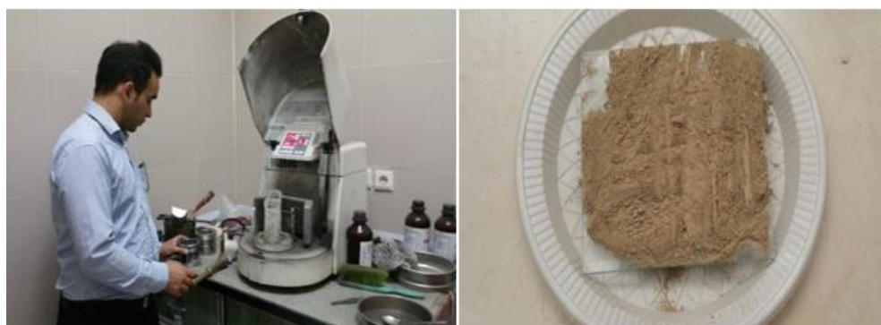
شکل ۳: نمایی از دستگاه آسیاب گلوله ای سیاره ای و نمونه های پودر شده مورد استفاده در تحقیق حاضر
