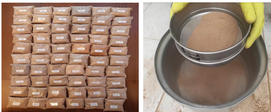
شکل ۳: الک کردن نمونه‌ها با استفاده از الک ۶۳ میکرومتر و بسته‌بندی و کدگذاری آنها
