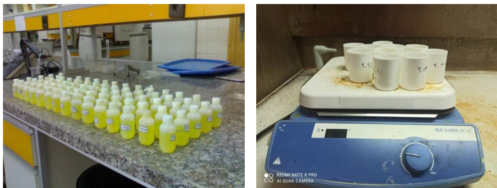
شکل ۴: آماده سازی نمونه ها بر روی دستگاه گرم کن و هضم نمونه ها در اسید
