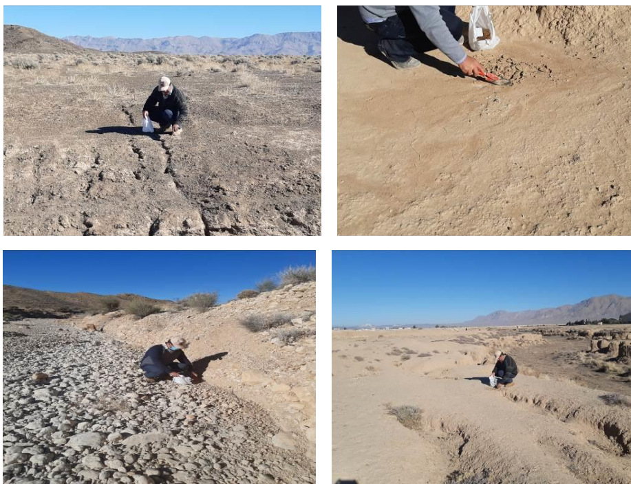
شکل ۲: برداشت نمونه از فرسایش ورقه‌ای، شیاری، خندقی و آبراهه‌ای
